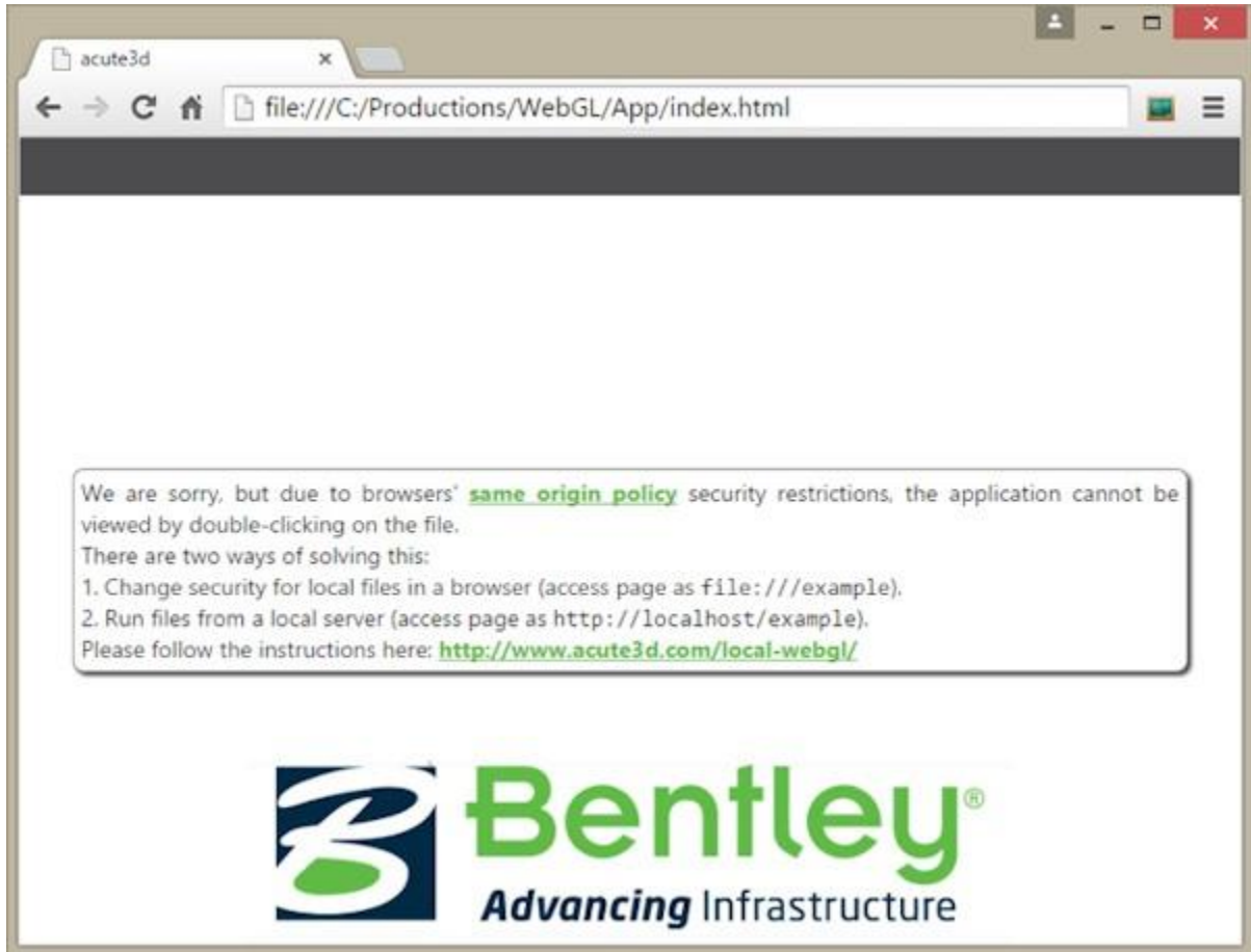
图106：双击该 Web 应用程序 (index.html) 将在浏览器中显示一条警告，因为所有浏览器实施相同的初始策略。
